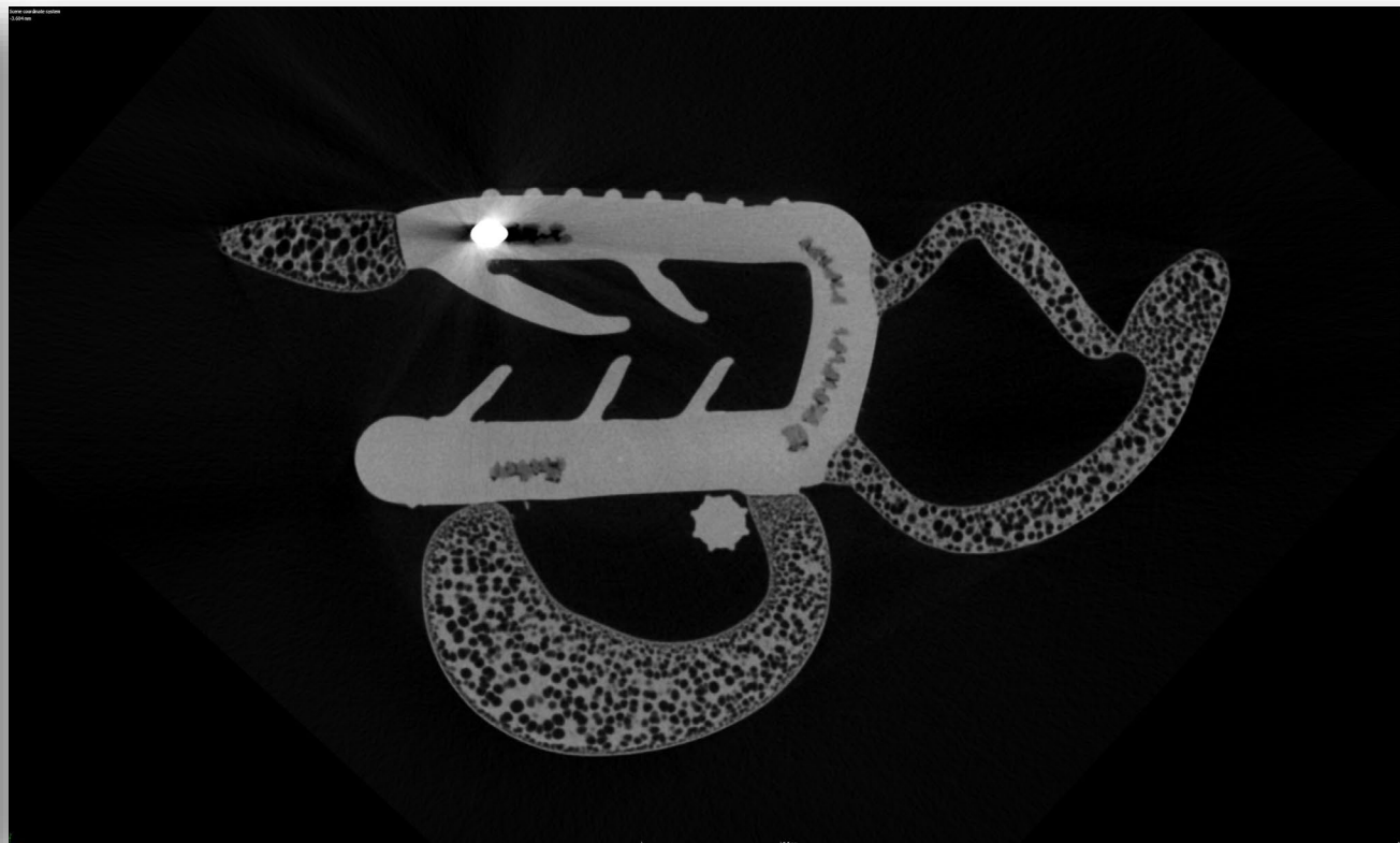
Sezione tomografica per valutazione superfici di interfaccia tra elementi ad alta densità con elementi a bassa densità
